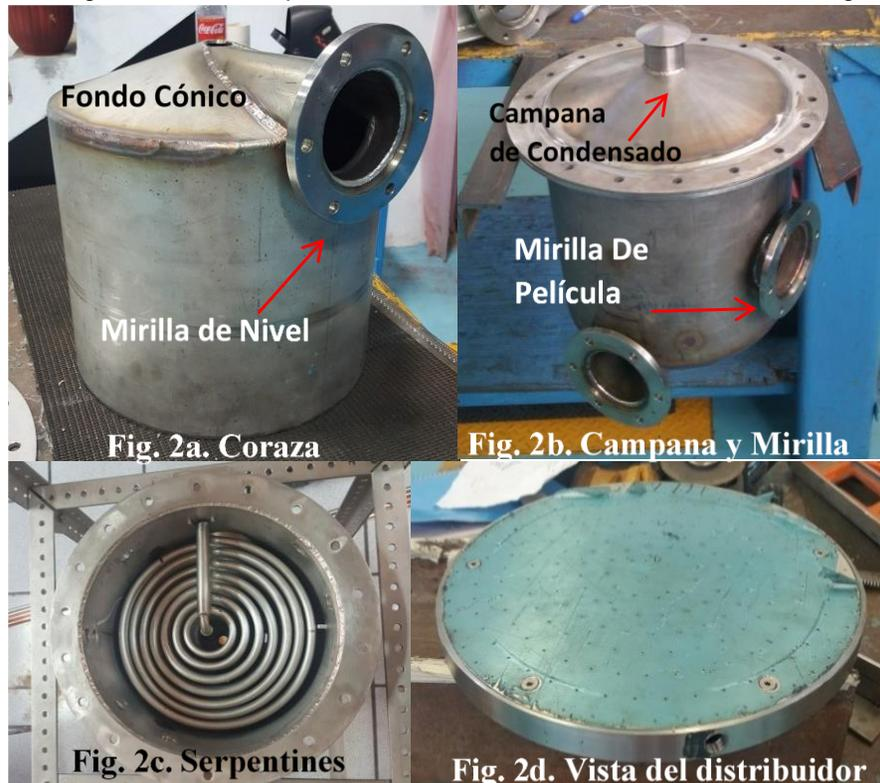
Figura 2. Componentes del Evaporador.
