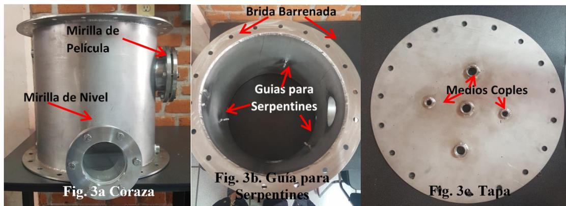
Figura 3. Componentes del Condensador.
